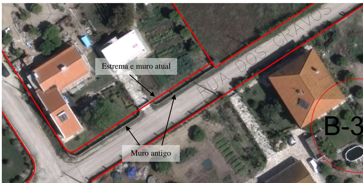
Figura 1- Indicação da estrema e muro atual e muro antigo
