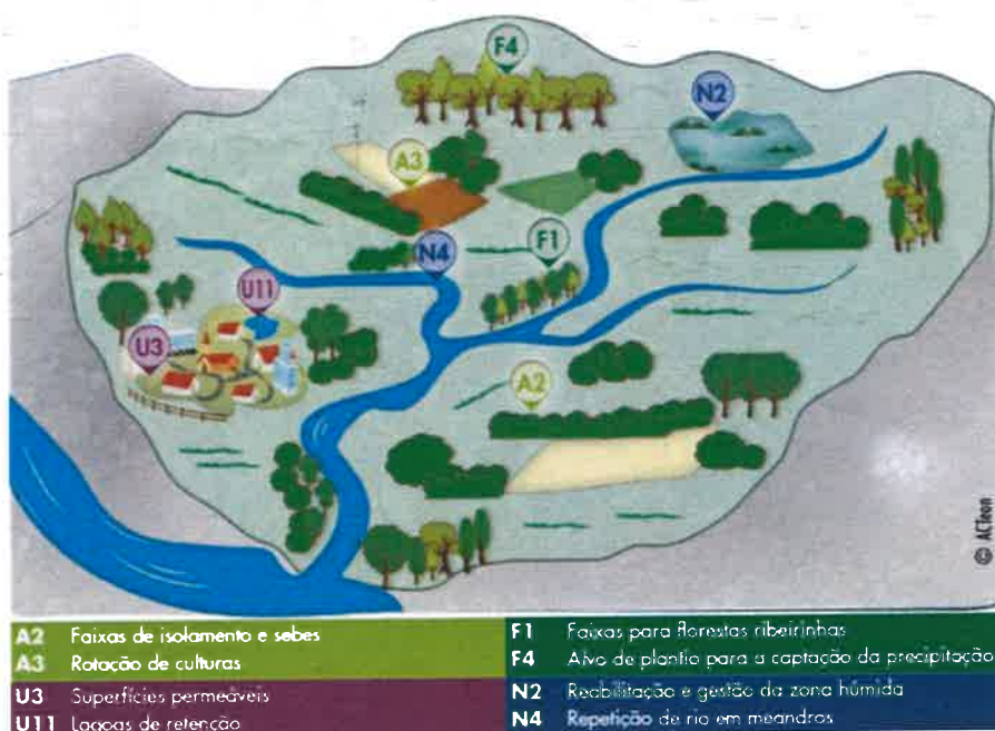
Figura 34 - Representação esquemática de uma bacia hidrográfica e implementação de medidas verdes (NWRM, 2013).
