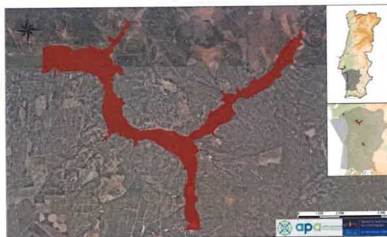
Figura 17 – Área inundada para o período de retorno de 100 anos, ARPSI de Alcácer do Sal
