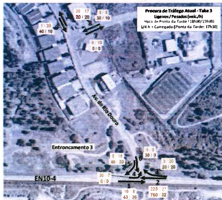
Figura 6.2 – Procura de Tráfego Atual no Take 3 (Entroncamento 3) Hora de Ponta da Tarde (18h00/19h00) e ¼ de Hora + Carregado (Ponta da Tarde: 17h30)
