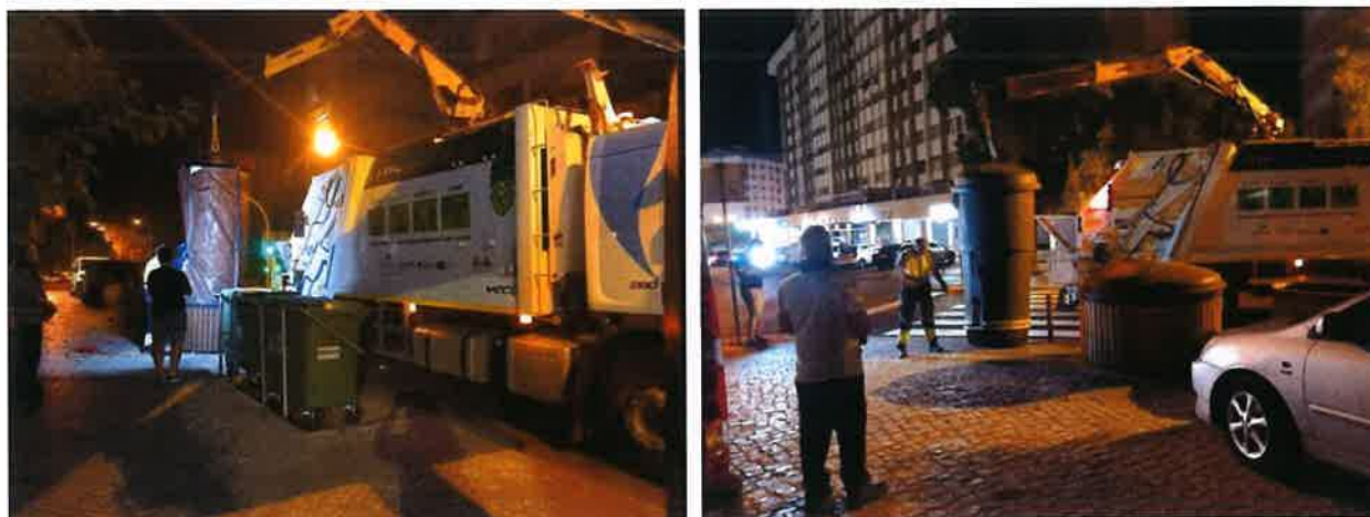
Figura 16 - Recolha de biorresíduos em contentores enterrados
