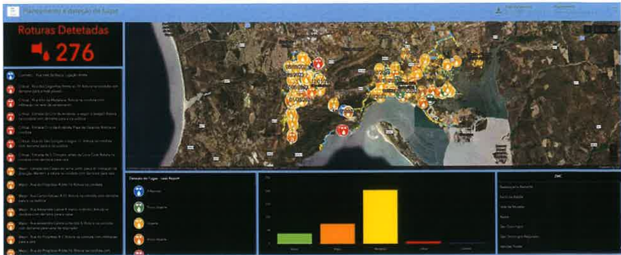
Figura 27 – Mapeamento das roturas detetadas
