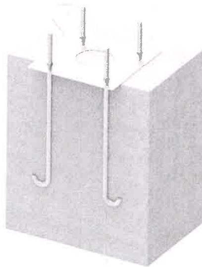
Figura 6 - Montagem das hastes de ancoragem.
