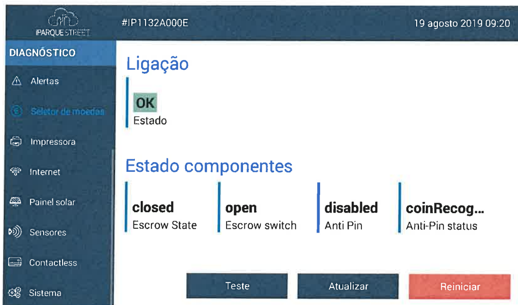
Figura 18 - Estado da ligação e dos componentes do seletor de moedas.
