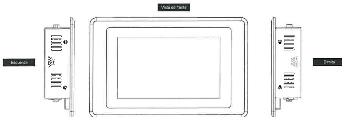
Figura 13 - Vista esquerda, frente e direita da unidade de controlo (DES0009).
