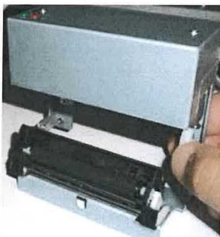
Figura 28 - Abrir a cabeça de impressão da impressora.
