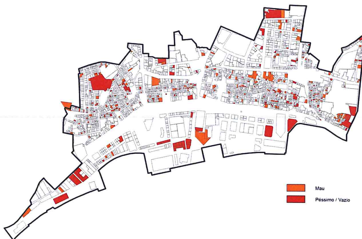
Figura 75 - Planta com Prédios urbanos com Estado de Conservação Mau, Péssimo e vazios - Ações Urgentes
