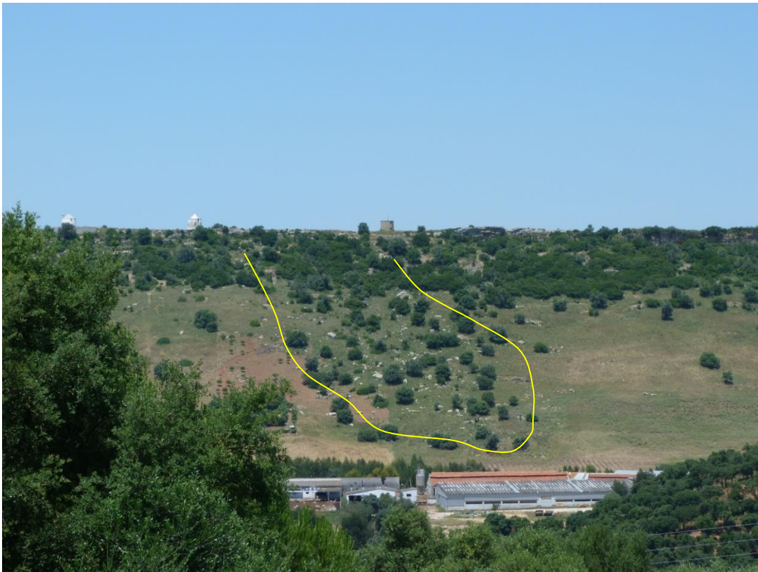
Figura 4.16 - Movimentos de massa antigos e mal conservados de tipo deslizamento / desabamento na Serra de S. Francisco.
