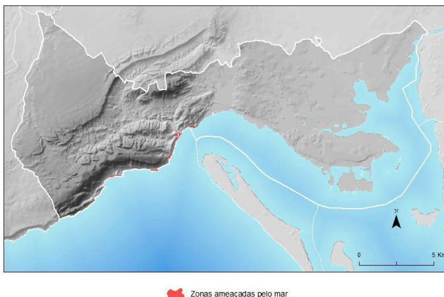
Figura 4.62 – Mapa de Setúbal com as zonas de elevada suscetibilidade à ocorrência de inundações por galgamento oceânico. Fonte: Zêzere et al (2013)
